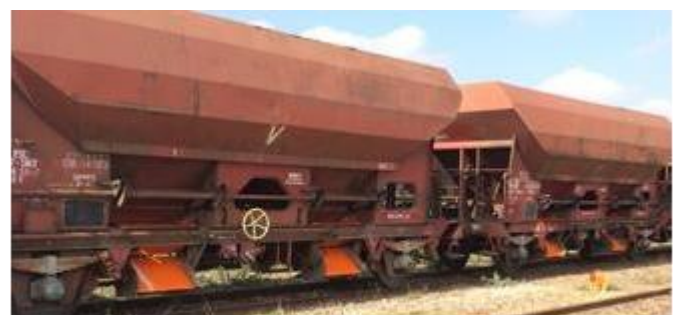
Train de ballastage en France protégé par les plaques anti-bruit mise au point par la société FIMOR
