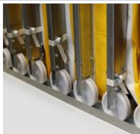
Guide a terra per agevolare lo scorrimento delle ruote.
