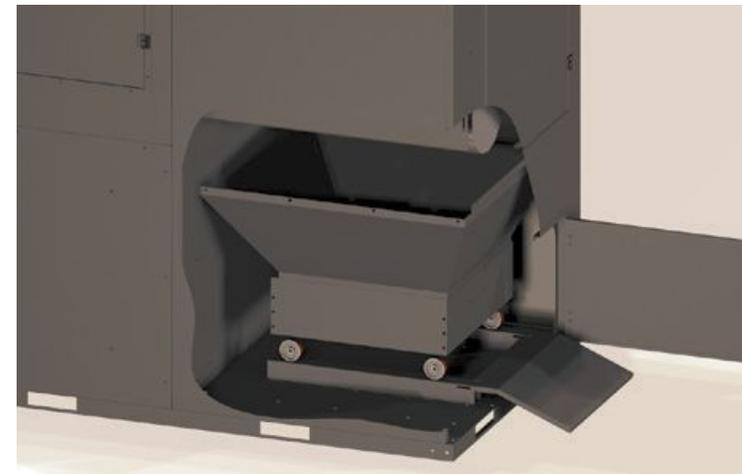
sistema di scarico polveri con carrello su ruote
