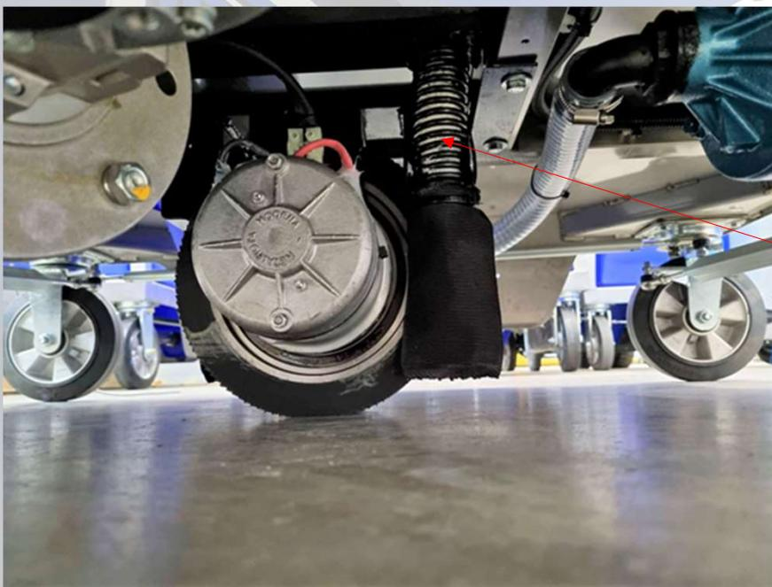
La ruota centrale posta centralmente è dotata di un sistema di molle brevettato, che spingendo verso il basso la ruota garantisce sempre un contatto ottimale con il suolo.
