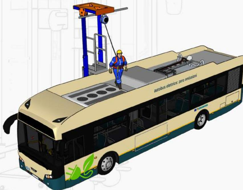
**B-SAFE** è stato concepito per essere estremamente **sicuro** in tutte le fasi di lavoro oltre ad essere **pratico e semplice** da mettere in esercizio. Inoltre, **l'ingombro a terra ridotto** rende B-SAFE un dispositivo in grado di muoversi anche all'interno di corsie e spazi stretti.
