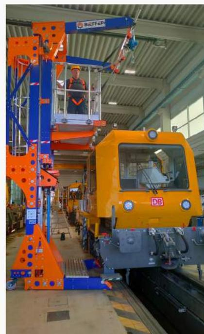
**TRAIN STEP - XS** è stato concepito per essere estremamente **sicuro** in tutte le fasi di lavoro oltre ad essere **pratico e semplice** da mettere in esercizio. Inoltre , **l'ingombro a terra ridotto** rende **TRAIN STEP-XS** un dispositivo in grado di muoversi anche all'interno di corsie e spazi stretti.
